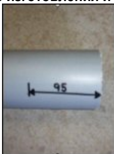
1. Отмерьте 95 мм от края трубы шнека.
