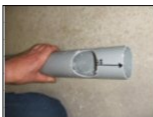
7. Когда отверстие будет готово, обточите его напильником, чтобы края были ровными.
